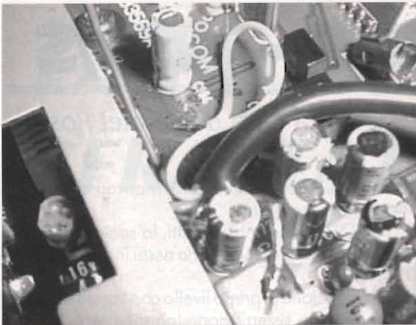
Foto 3 - Particolare del collegamento per prelevare il segnale in ricezione.
